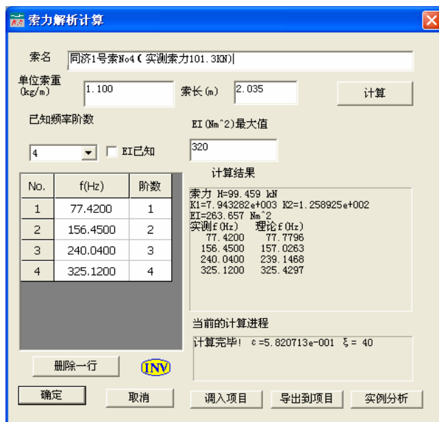
图 2 使用东方所的精确算法计算结果，同时还能得到所的 EI=263.6 Nm 2
