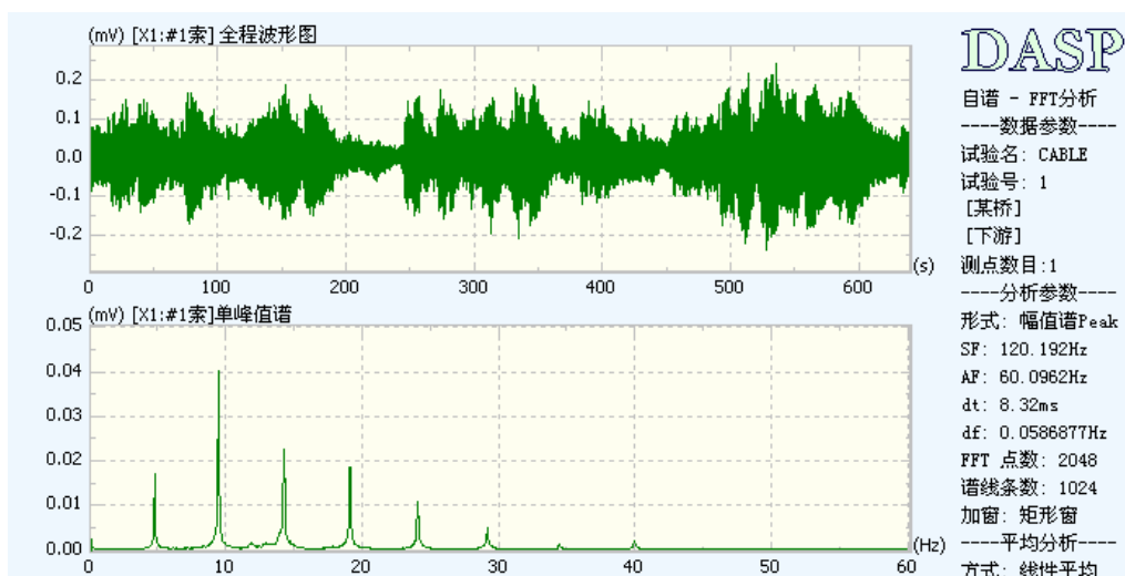
图 3 振动频谱图上的频率阶数非常清晰
